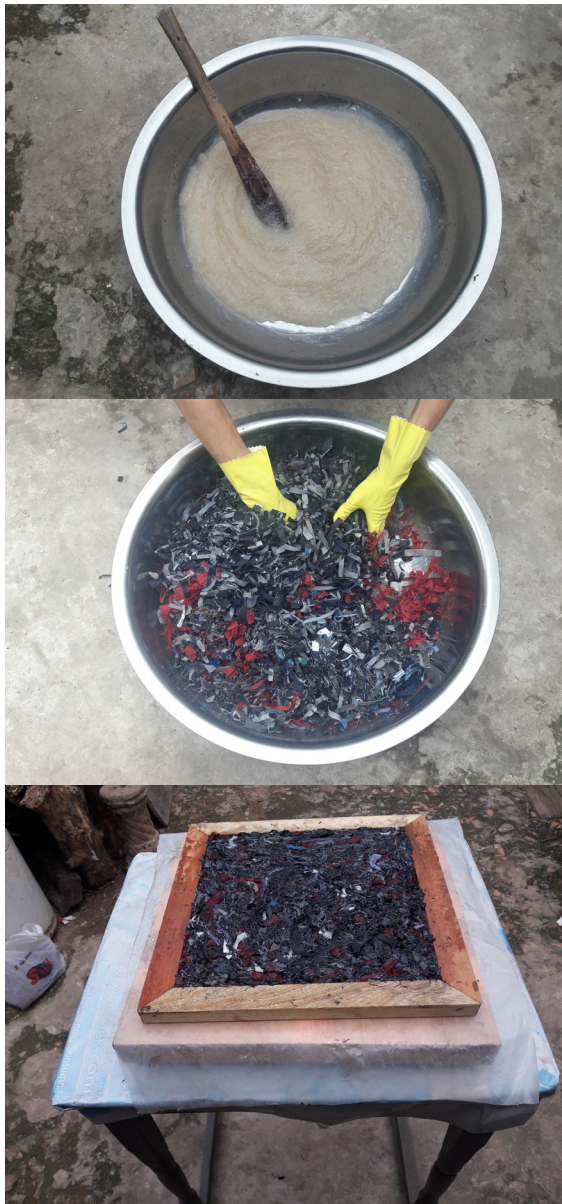
Imagen 25. Proceso de fabricación de placas aglomeradas a partir de retazos de tela. Fase de experimentación. Fuente: Elaboración propia.
